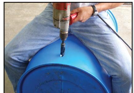
Perforación del orificio de desbordamiento.
